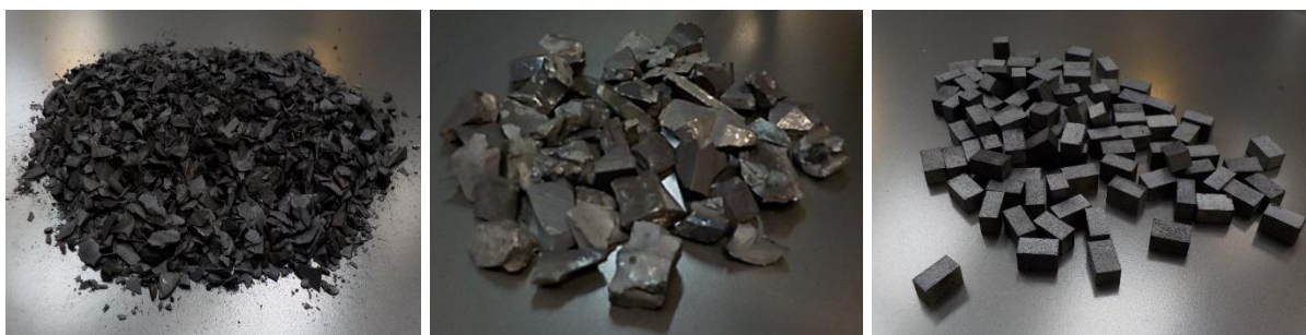
Figura 11. Diferentes tamanhos de partícula usados na produção de placas composto FFN/metal duro, 2 mm <MD<4 mm, MD >8 mm e BD 20, da esquerda para a direita.
