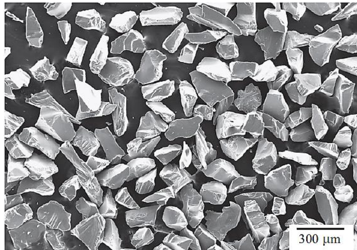
Figura 34. Micrografia SEM de partículas erodentes de SiC 45 .
