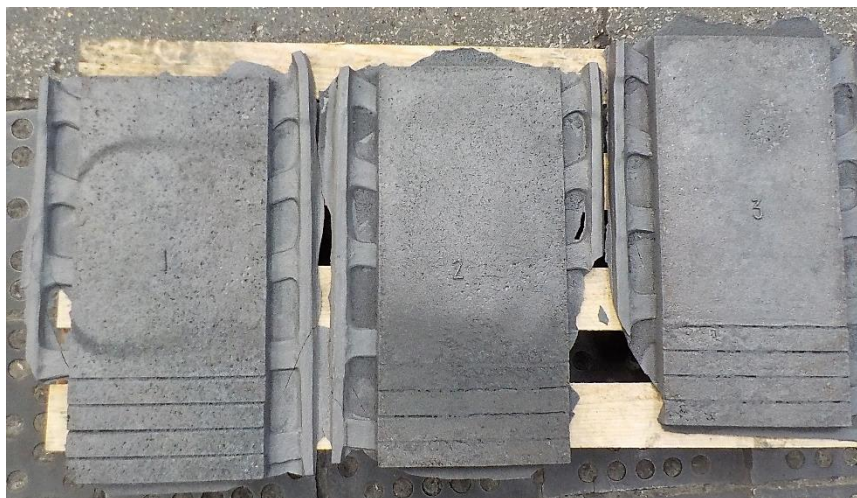
Figura 13. Placas de compósito FFN/metal duro, ainda com sistema de gitagem, com acrescentos para caracterizações mecânicas, relativo ao ensaio com a liga EN-GJS-700-2.
