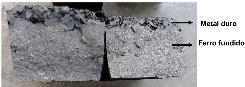
Figura 33. Imagem representativa da fratura dos provetes da liga EN-GJS-600-3, placa 1, com granulometria de 2\text{ mm} < MD < 4\text{ mm} .
