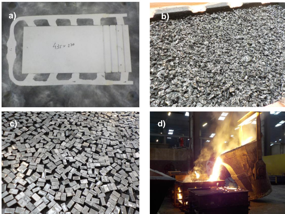
Figura 12. Sequência de produção das placas compósitas de metal duro-ferro fundido: a) produção da moldação com o molde em EPS; b) e c) aplicação de partículas de metal duro, 2 mm <MD<4 mm e BD20 respetivamente; d) vazamento do FFN para o interior das moldações.
