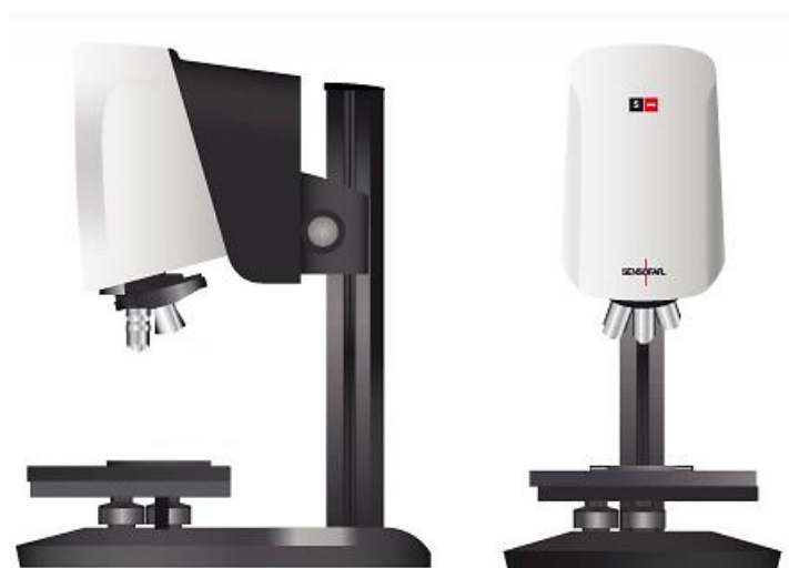
Figura 17. Equipamento de caracterização de perfilometria ótica 3D, Sensofar S-neox 44 .
