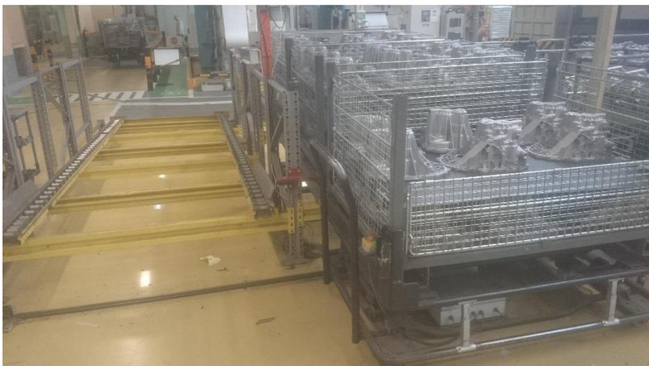
Figura 63 - Estrutura de armazenamento de contentores de cárteres
