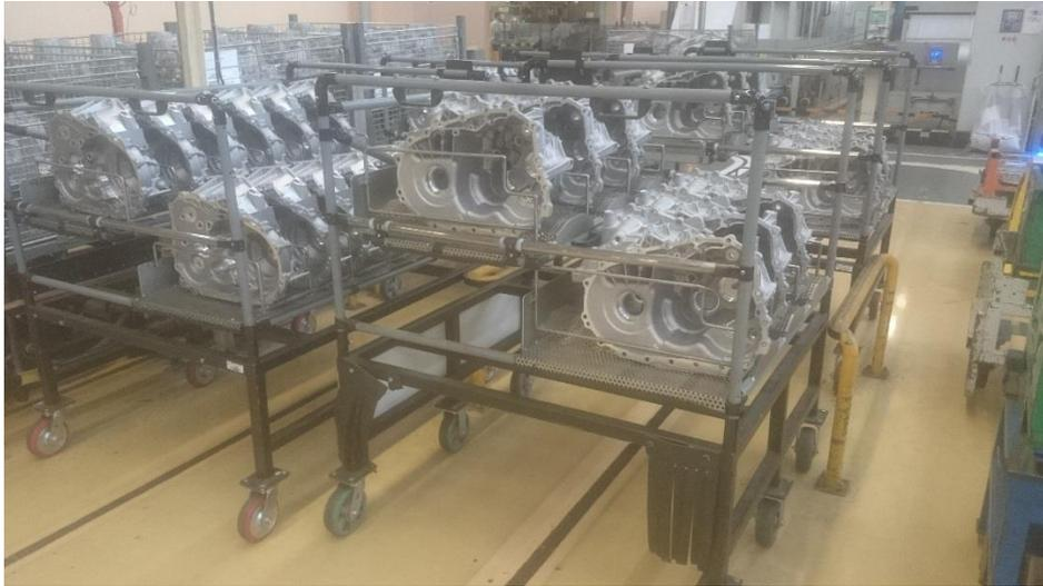
Figura 64 - Bases de transporte de cárteres para AGVs
