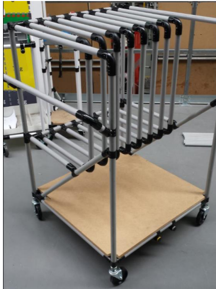
Figura 44 - Carrinho para transporte de painéis (mdf, pvc e chapas).
