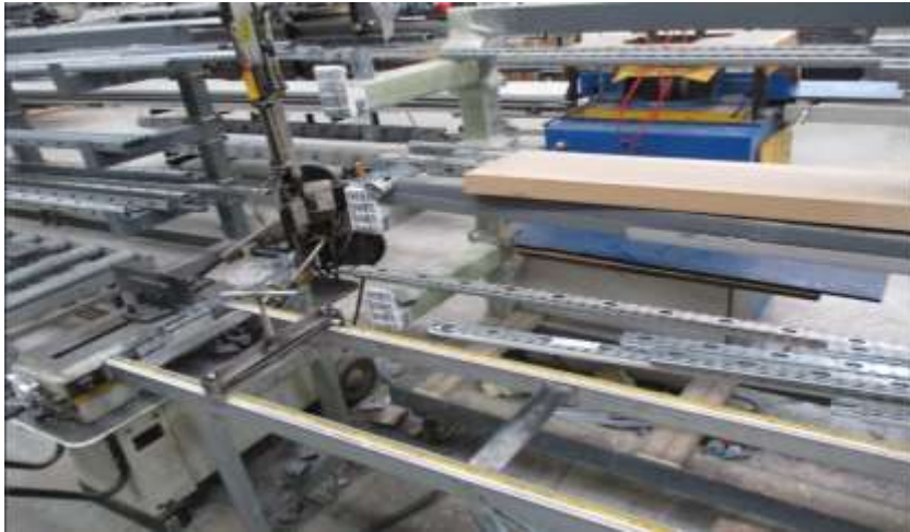
Figura 32: Necessidade de limpeza no exterior do serrote de fita.
