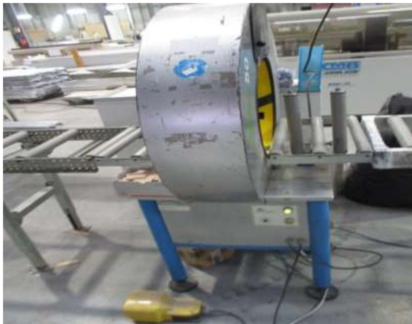
Figura 26: Embaladora de perfis de alumínio.
