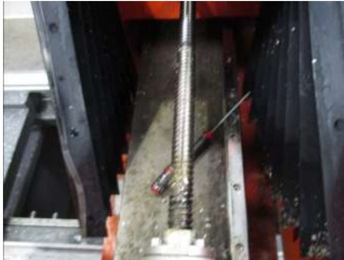
Figura 34: Necessidade de limpeza da grade superior do mandril eléctrico.
