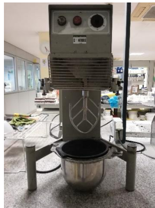
Figura 7 - Misturadora com características de acordo com a norma NP EN 196-1 (CEN, 2006a) [25], marca Controls, modelo 65-L0005, com âncora de altura 130 \pm 1 \text{ mm} , pá de altura 179 \pm 1 \text{ mm} e diâmetro de recipiente 200 \pm 1 \text{ mm} , utilizada na amassadura automática dos produtos em estudo.
