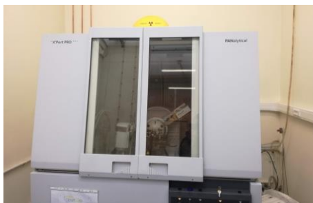
Figura 12 - Difratómetro de raios X PANalytical X'Pert PRO 3 .
