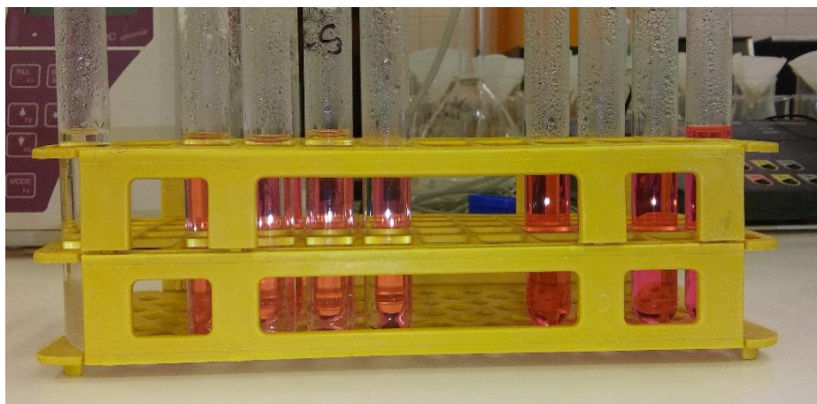
Figura 15 - Avaliação da incidência da peroxidação lipídica no músculo longissimus de carne de porca, através do método TBARS. – Esta determinação é feita com base na formação de um complexo rosa que resulta da reação do ácido tiobarbitúrico com o malondialdeído presente na amostra, cuja absorvância pode ser determinada a 530 nm.
