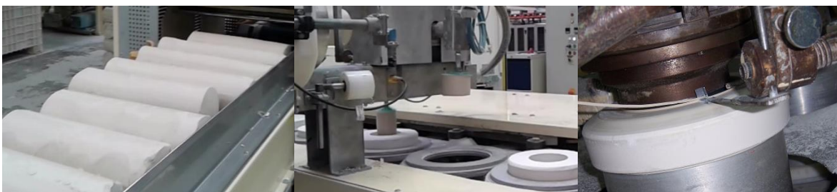
Figura 5 – (a) “Tarulos” de pasta cerâmica plástica; (b) Conformação por contramoldagem numa máquina Roller .
