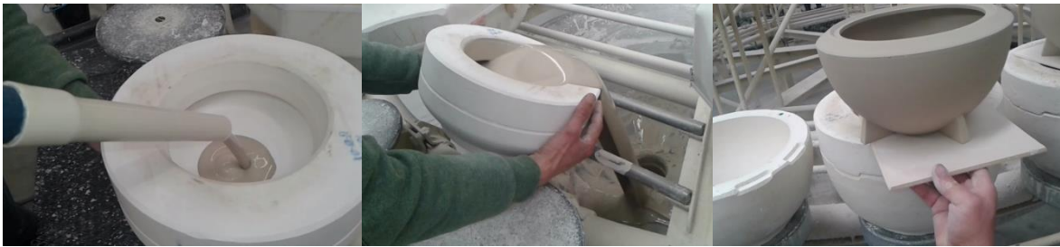
Figura 3 – Conformação de peças de olaria por enchimento à pressão atmosférica de formas de gesso.
