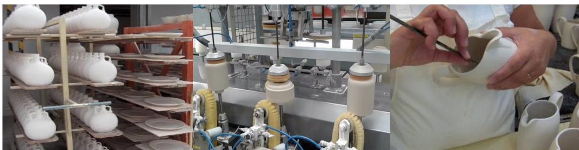
Figura 7 – Secagem das peças e posterior polimento e aperfeiçoamento.
