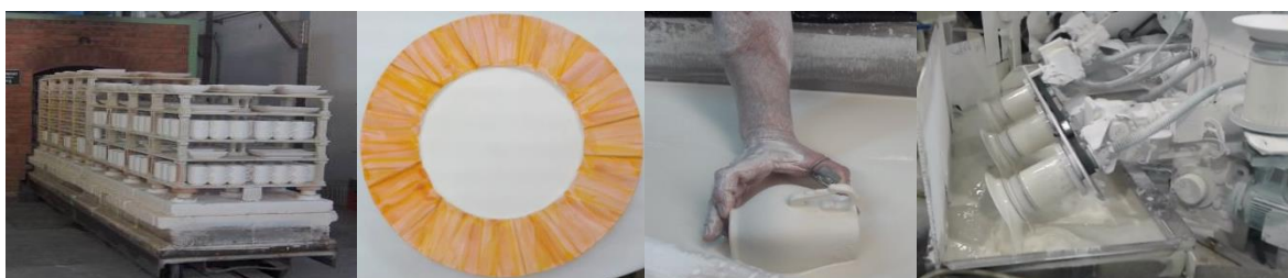
Figura 8 – (a) “Vagona” com loiça para chacotar; (b) Prato com cera “anti-vidro”; (c) Vidragem manual; (d) Vidragem automática.
