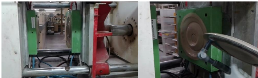
Figura 4 – Conformação por enchimento a alta pressão nas MEAP.
