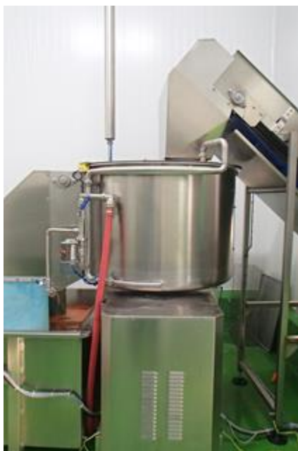
Figura 22. Tambor rotativo para descascamento da cenoura.
