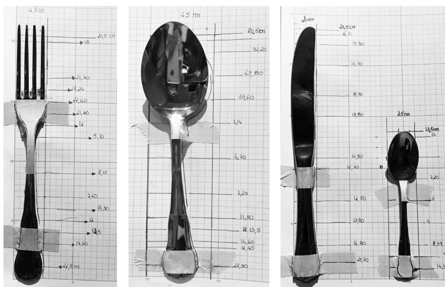
fig. 76 | análise metrológica do garfo, da colher, da faca e da colher de chá
