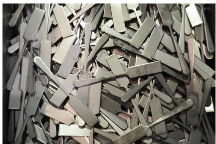
fig. 29 | peças cortadas em chapa de aço inoxidável
