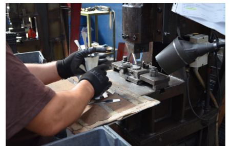
fig. 94 | processo de prototipagem, marcação de marca por prensa
