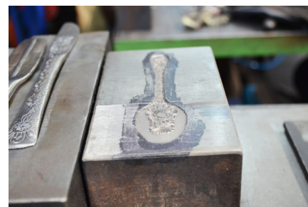
fig. 26 | molde com detalhe de estampa
