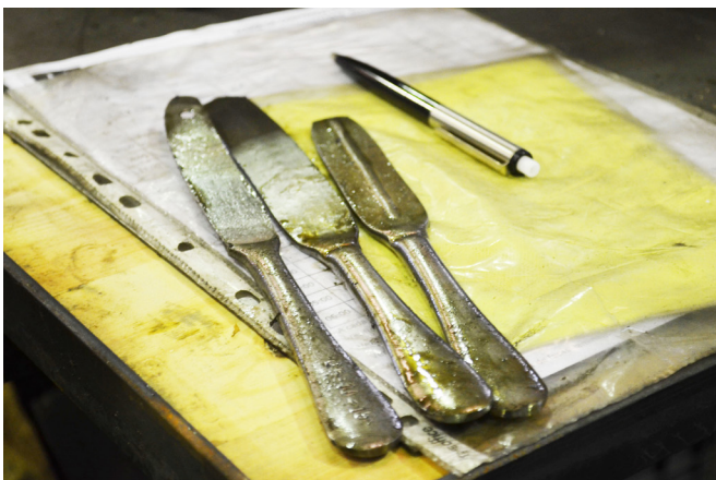
fig. 36 | evolução da laminagem da faca
