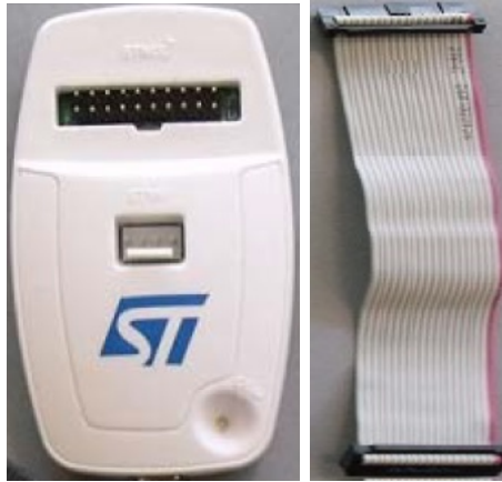
Figura 4.13: ST-LINK/V2 e um SWV flat ribbon com 20 pinos, respetivamente [64].
