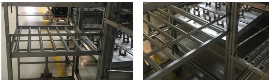
Figura 60 – Abastecimento por carros com tabuleiros e roletes
