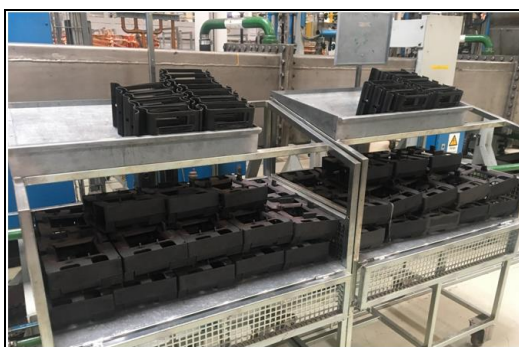
Figura 37 – Carros de abastecimento de grelhas
