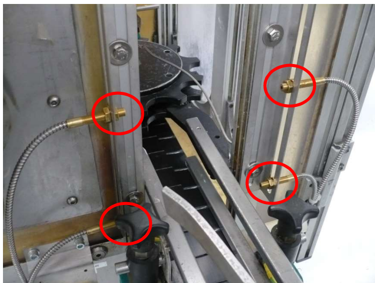
Figura 57: Sensores máquina dos atuadores
