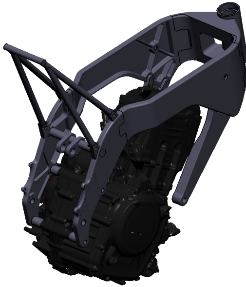
Figura 3.23: Geometria dentro dos parâmetros de rigidez com o motor da organização (vista de trás).
