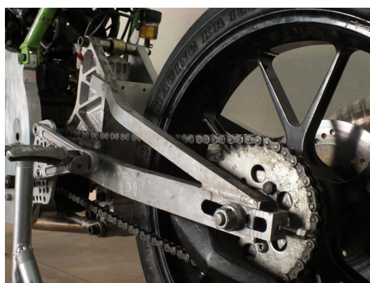
Figura 3.3: Escora construída pela equipa Motochanics.
