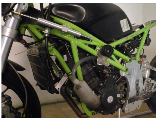
Figura 3.2: Quadro construído pela equipa Motochanics.
