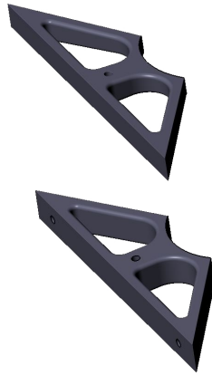
Figura 3.28: Reforço frontal após alterações.
