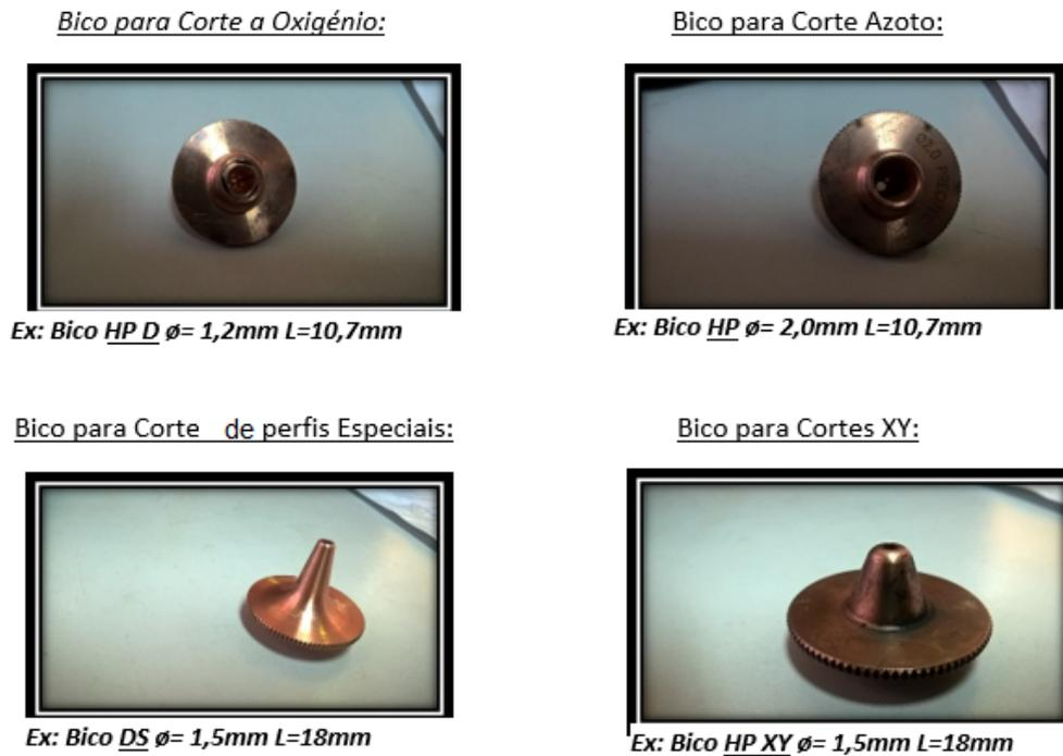
Figura 3.23: Diferentes tipos de bicos (cortesia Jamarcol);
