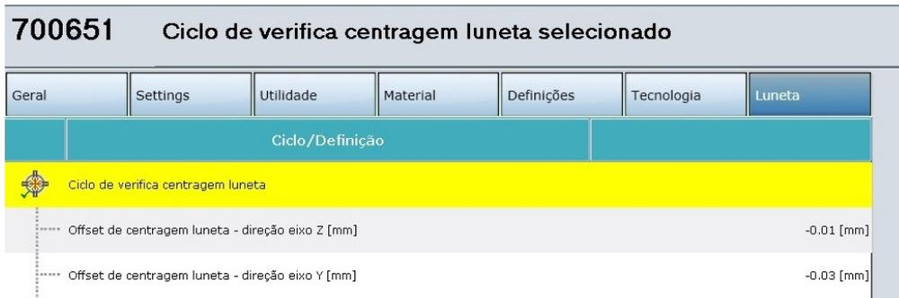
Figura 3.21: Ambiente Gráfico em máquina - Ciclo de centragem Luneta (cortesia Jamarcol);
