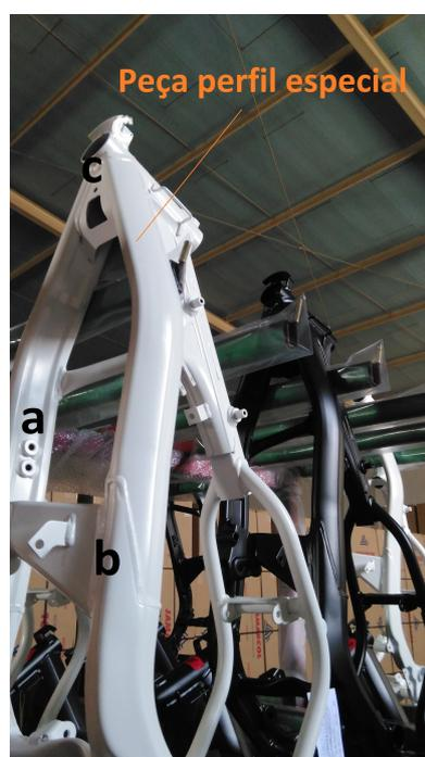
Figura 4.13: Perfil tubo especial - Aplicação do tubo perfil especial;
