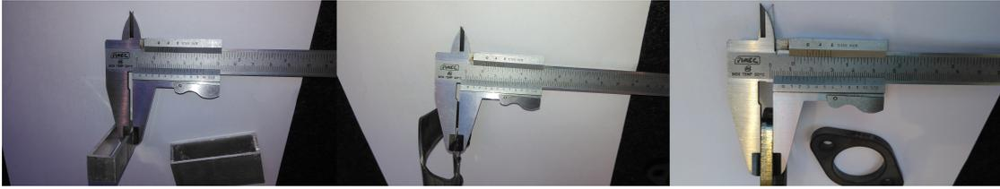
Figura 3.28: Medição dos valores dos 3 tipos de matéria prima - paquímetro;
