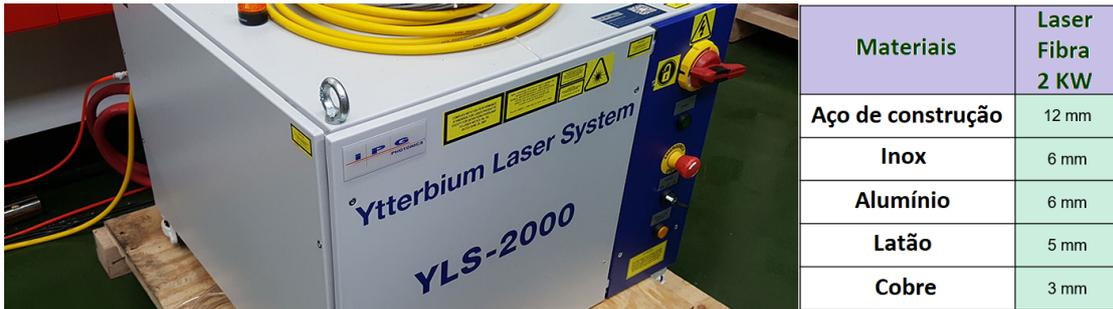
Figura 3.5: Fonte laser e espessuras máximas admissíveis de corte para os diferentes tipos de materiais (cortesia Jamarcol);
