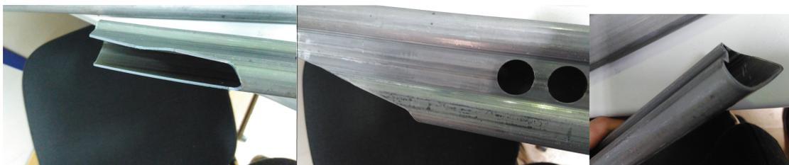
Figura 3.44: Perfil Especial - Corte parâmetros otimizados;
