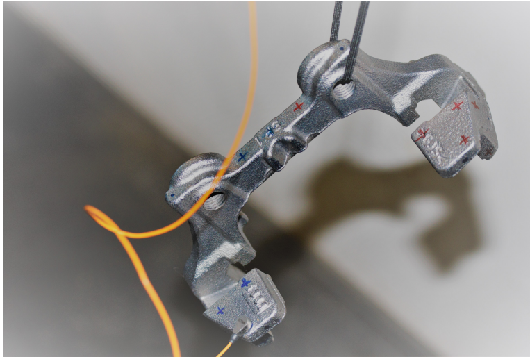
Figura 6.1: Esquema de fixação em condições de corpo livre.
