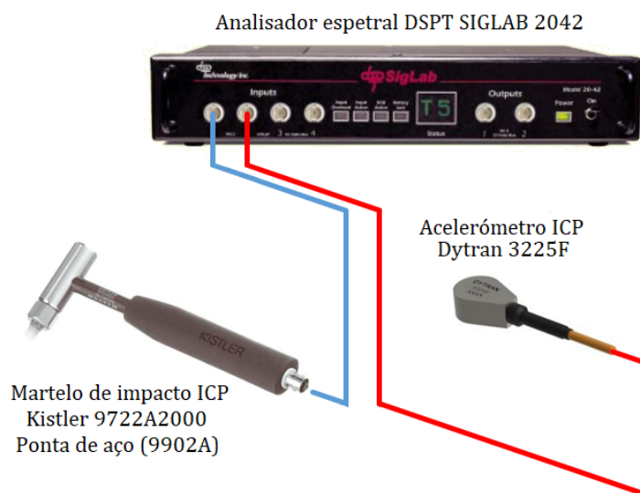
Figura 6.9: Configuração do ensaio modal experimental.
