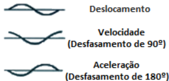
Figura 6.5: Desfasamento de uma onda em termos de deslocamento, velocidade e aceleração [43].
