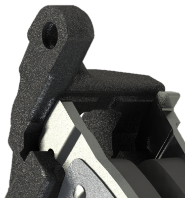
Figura 8.6: Placa de apoio inserida na calha do suporte do travão.
