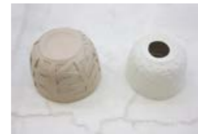
Fig. 263 Fotografia de uma das peças antes de cozer e outra feita com mesmo molde mas cozida
