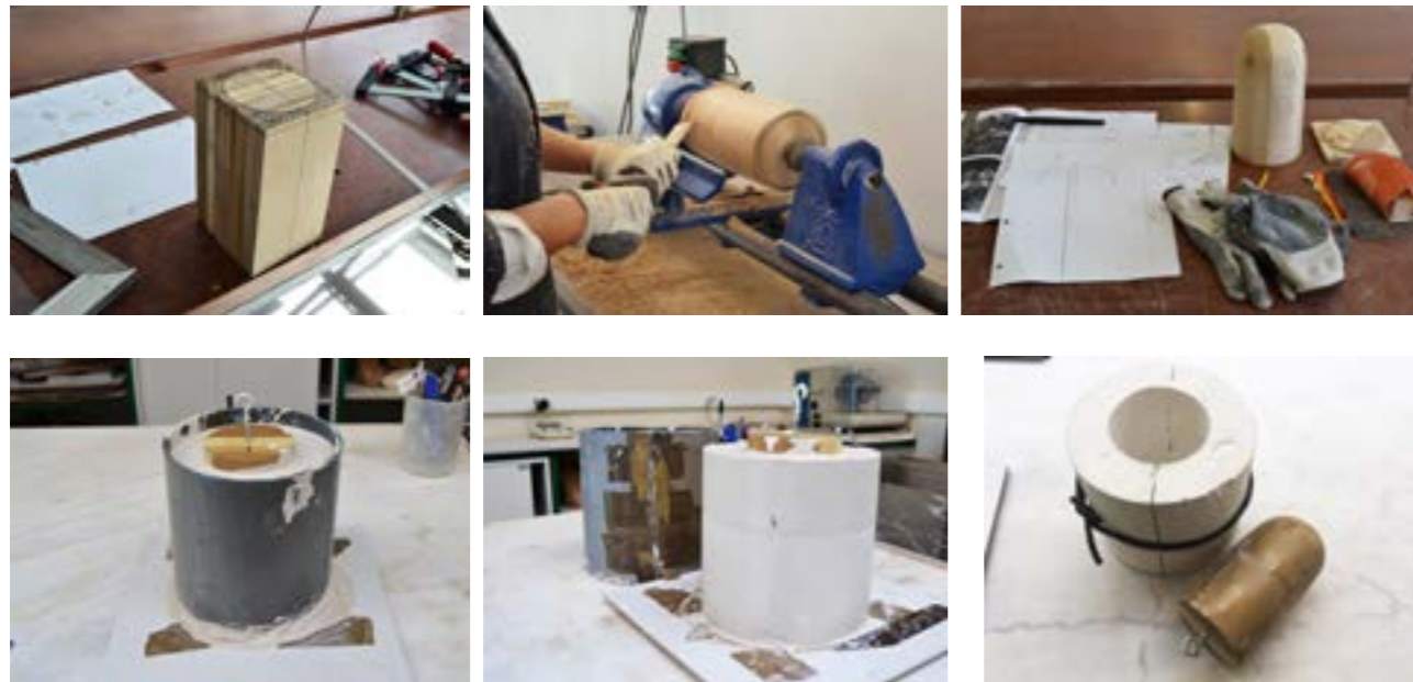
Fig. 227 a Fig. 232 Fotografias do processo para fazer o molde em gesso.
