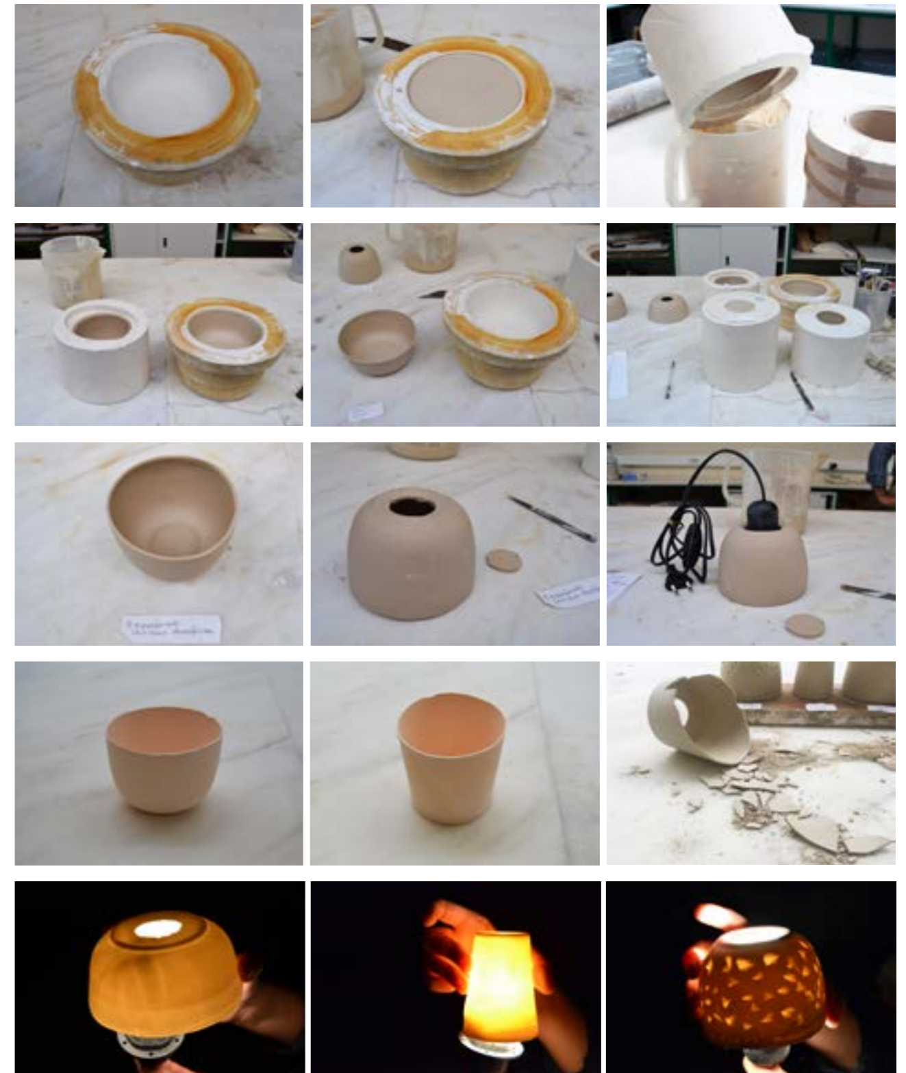
Fig. 233 a 247 Fotografias do processo de moldagem por enchimento e primeiros resultados de porcelana translúcida. Fonte: imagem do autor
