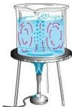
fig. 32 - Movimento das correntes de convecção natural
