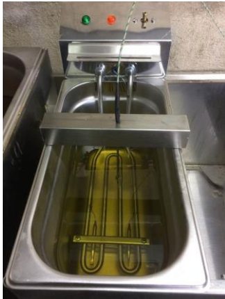
fig. 63 - Ensaio do aquecimento do óleo na fritadeira de 4 lts da PNH
