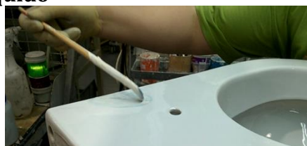
Figura 12 - Ilustração do incremento de vidro líquido indicado para defeitos lisos e de grandes dimensões.
