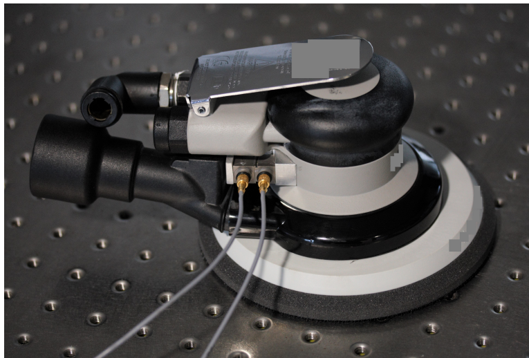
Figura 5.28: Fotografia dos dois acelerômetros montados na ferramenta pneumática.
