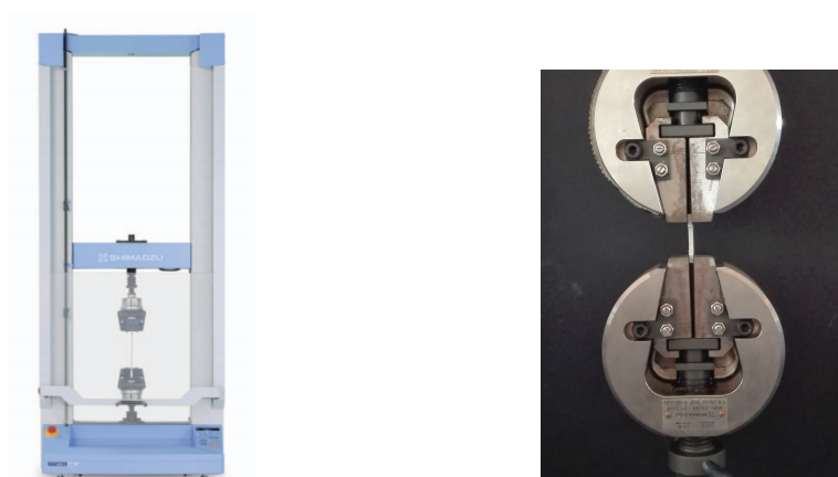
(b) Montagem dos provetes para ensaio.
