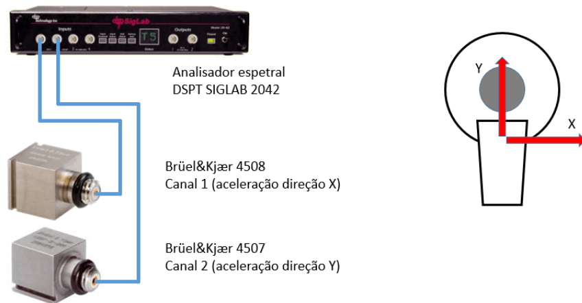
Figura 5.27: Esquema ilustrativo dos equipamentos utilizados no estudo e respetivo sistema de coordenadas.
