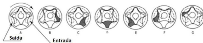
Figura 2.14: Funcionamento bomba de óleo engrenagens dentado interior do tipo G-Rotor. Adaptado de [15].
