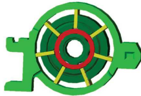
Figura 2.18: Anel de centragem das palhetas (a vermelho).
