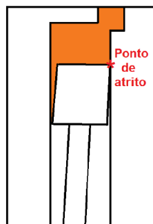
Figura 4.34: Ponto de atrito entre a válvula e as paredes do alojamento.
