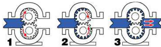
Figura 2.10: Funcionamento Bomba de óleo de engrenagens de dentado exterior [15].
