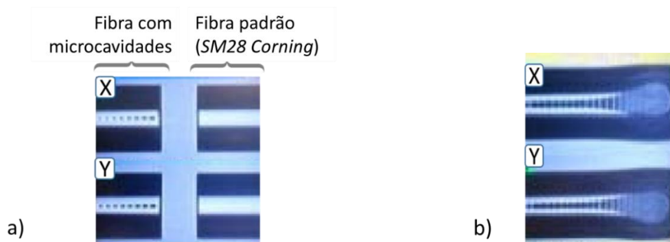
Figura 4.2 – Fotografias retiradas durante o processo de fusão: a) alinhamento das fibras e b) cavidade resultante da fusão. X e Y representam as direções perpendiculares aos planos das fotografias [74].
