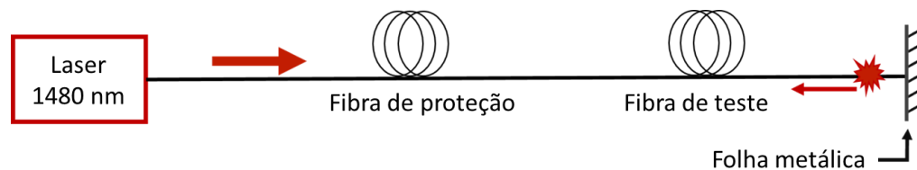
Figura 4.1 - Esquema da montagem experimental usada para induzir, de forma controlada, o efeito fusível. Adaptado de [73].
