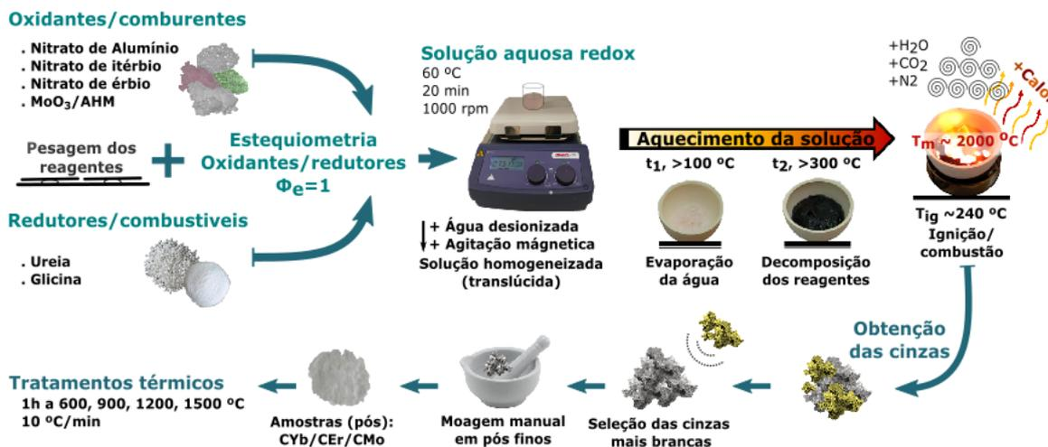
**Figura 3.2.** Esquema do processo de síntese pelo método SCS utilizado na produção dos pós de YbAG (amostras: CYb, CEr, CMol/II), e respetivo processamento, i.e., separação das cinzas, moagem e tratamento térmico. Adaptado de [36], [37] e [42].
