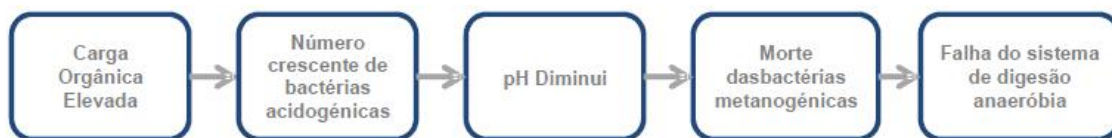
Figura 4.3 – Esquema explicativo do processo de inibição da digestão anaeróbia devido a uma elevada carga orgânica [35]
