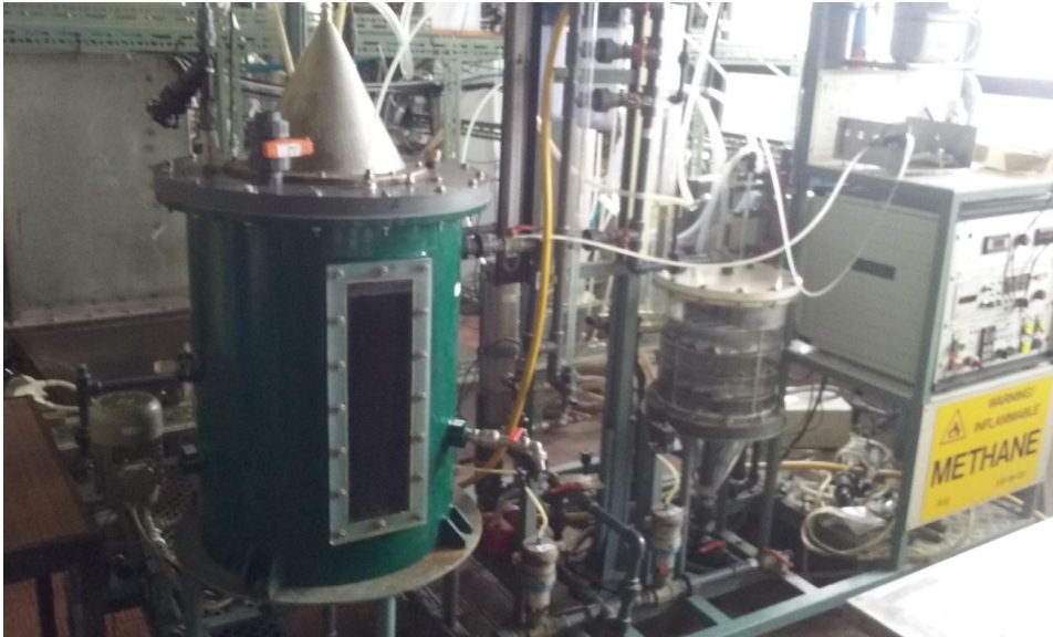
Figura 3.1 – Unidade laboratorial de digestão anaeróbia de biorresíduos
