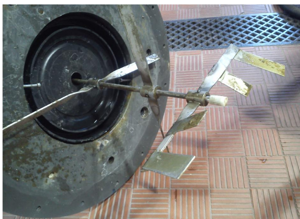
Figura 3.6 – Sistema de agitação de digestão anaeróbia em três níveis
