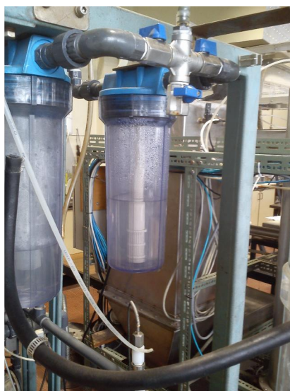
Figura 3.4 – Borbulhador de biogás e limitador de pressão de coluna líquida de 8 cm
