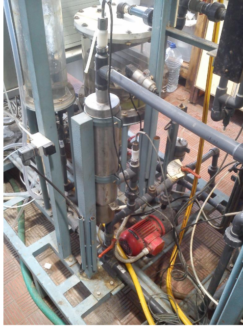
Figura 3.2 – Dispositivo externo de aquecimento e recirculação
