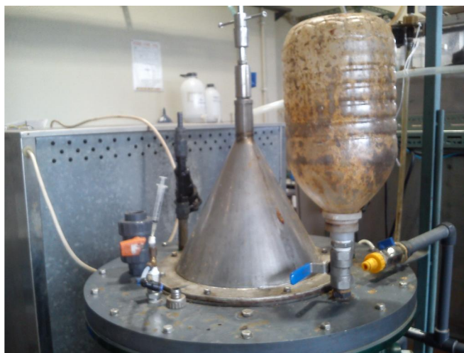
Figura 3.9 – Funil de alimentação ao digestor anaeróbio e válvula de controlo
