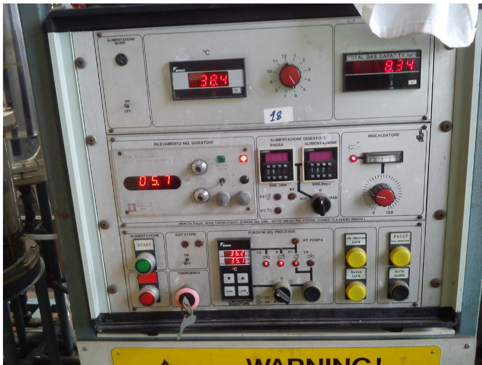
Figura A.2 – Unidade de controlo da unidade piloto de digestão anaeróbia do DAOUA
