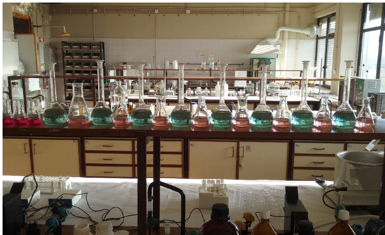
Figura 3.10 – Determinação do teor em azoto Kjeldahl das amostras no laboratório do DAOUA
