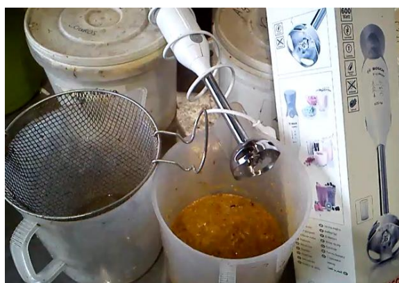
Figura 3.8 – Polpa de biorresíduos após trituração com varinha mágica e crivo
