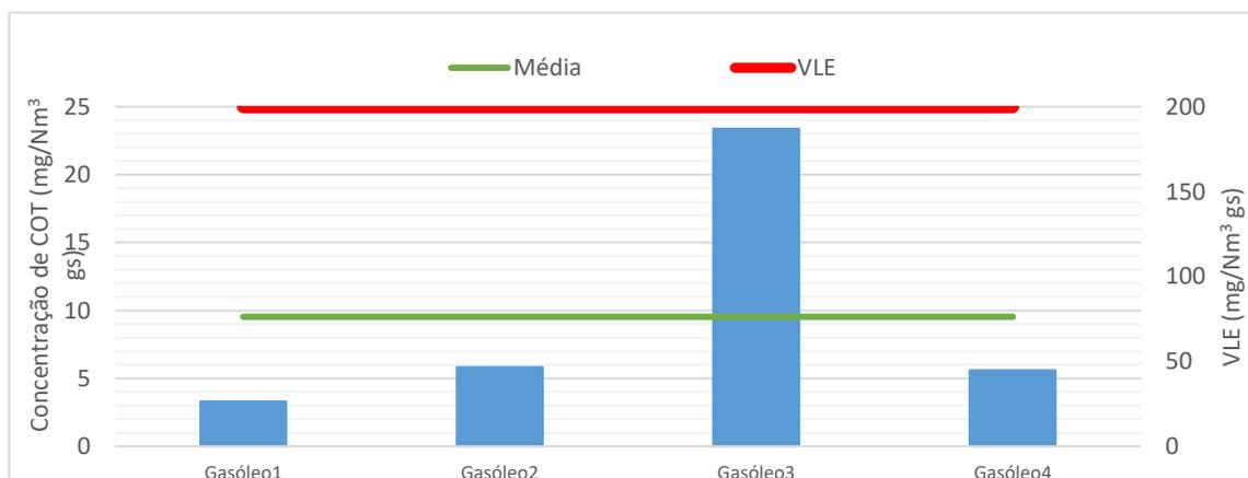
Figura 22. Comparação das concentrações de COT com média dos valores e VLE para caldeiras a gasóleo.
