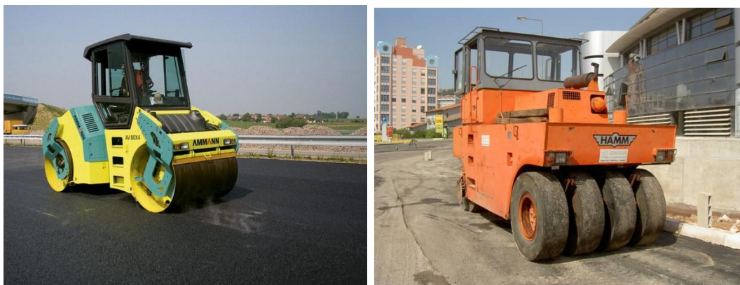
Figura 37 - Cilindro de rolo e cilindro de pneus utilizados na compactação das misturas betuminosas.
