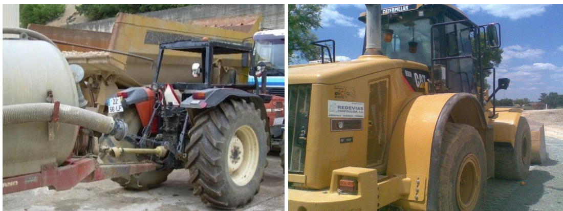
Figura 28 - Trator jopper para rega da camada de base e pá carregadora.
