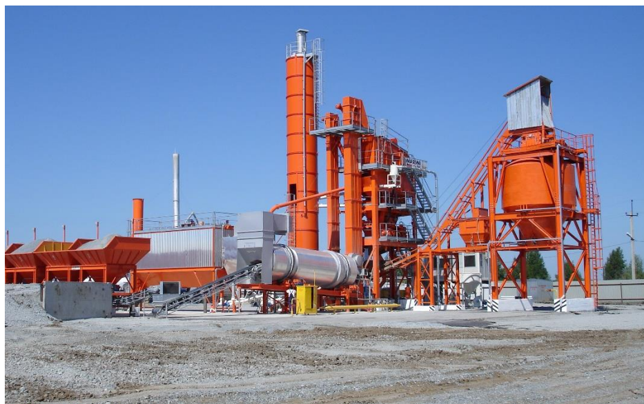
Figura 45 - Central de fabrico de misturas betuminosas MARINI ULTIMAP 2000.
