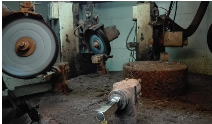
Figura 17 – Interior da Máquina de Polimento Automático em funcionamento
