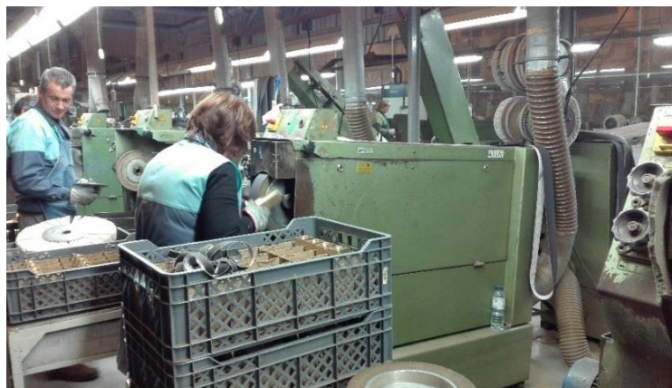
Figura 18 – Posto de Lixagem/Polimento/Murçagem Manual
