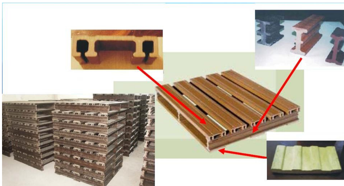
Figura 6: Paletes em WPC para utilização em instalações fabris (FTI – Products www.futuresoft.net ).
