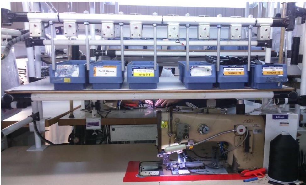
Figura 46. Implementação de sistema à prova de erro nas máquinas de costura de perfis
