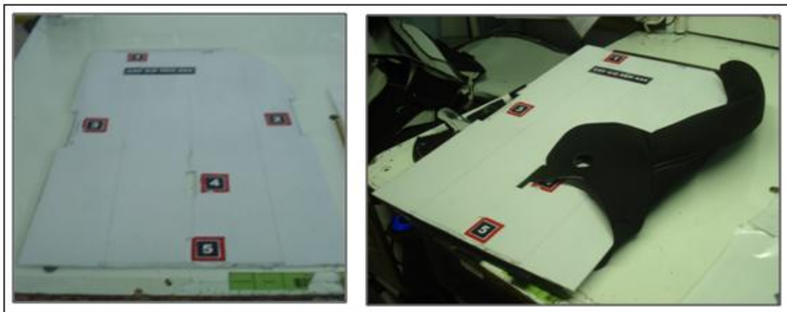
Figura 47. Aplicação de Gabary's no posto de Controlo Final mais "clipagem" da capa CAV no gabary
