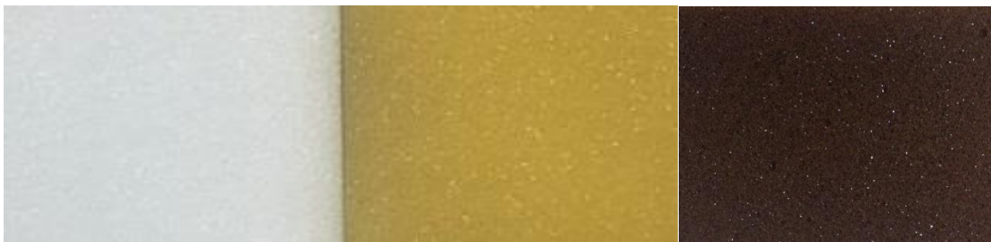
Figura 4-21 Espuma PE_D42 (5) no estado inicial (à esquerda), após envelhecimento seco em atmosfera inerte (ao centro) e após envelhecimento seco em atmosfera de ar (à direita)
