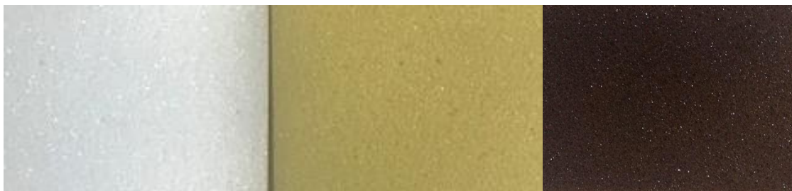
Figura 4-22 Espuma PE_D42 (6) no estado inicial (à esquerda), após envelhecimento seco em atmosfera inerte (ao centro) e após envelhecimento seco em atmosfera de ar (à direita)
