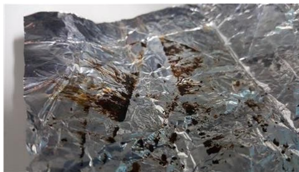
Figura 5-3 Material residual resultante do processo de laminação à chama
