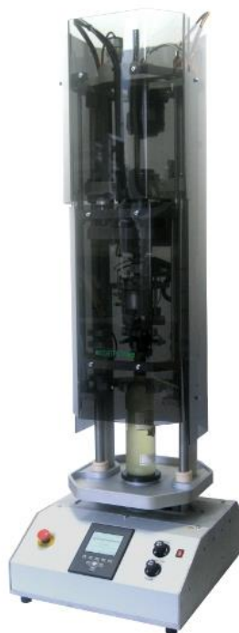
Figura 22: Sistema de medição da força de extração e Binário, ExtraLab Plus
