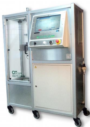
Figura 21: Sistema de teste de compressão, inserção e relaxação da rolha. Egitron.
