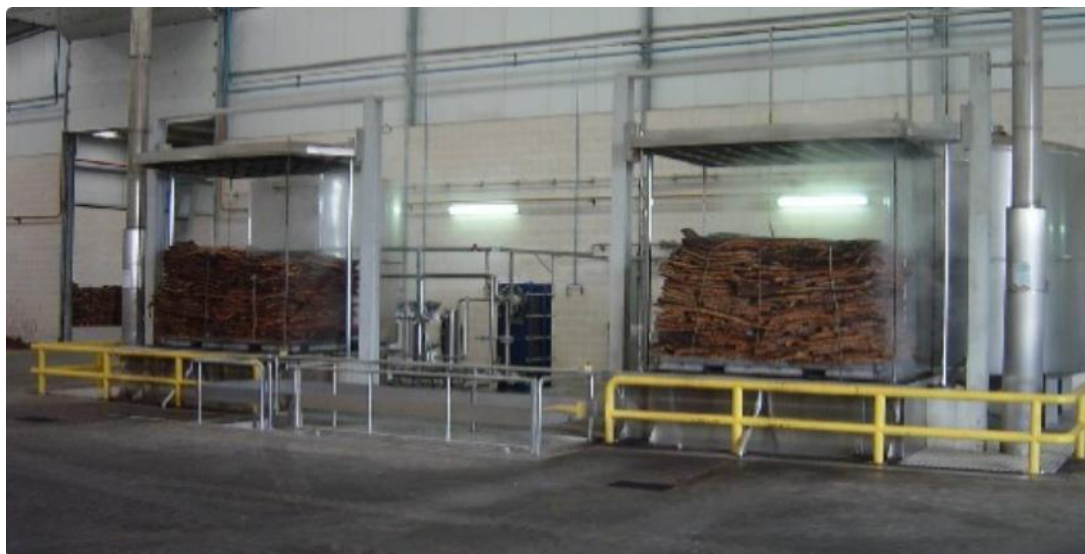
Figura 19: Cozedura das Pranchas- Caldeiras, Pietec Cortiças, SA.
