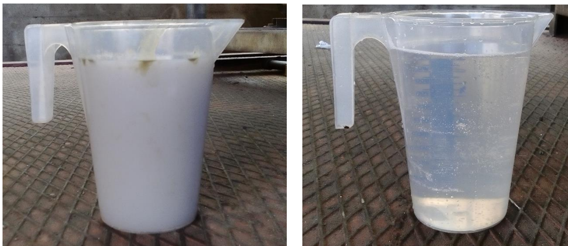
Figura 44 – À esquerda o efluente de entrada na membrana e à direita o efluente tratado da membrana (permeado).
