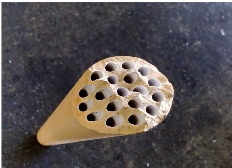
Figura 37 – Membrana (partida) de ultrafiltração tubular de 25 mm de diâmetro e com 19 canais, da marca Likuid Nanotek.
