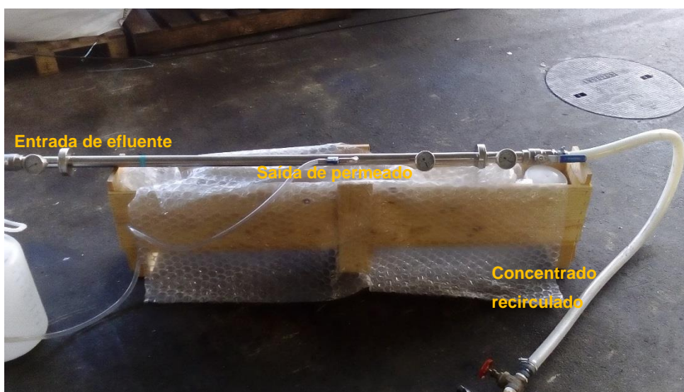
Figura 39 – Equipamento utilizado no ensaio da membrana de ultrafiltração.
