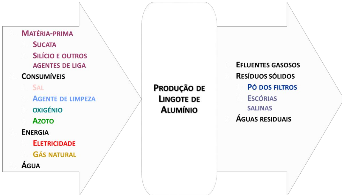
Figura 16 – Fluxos de entrada e de saída do processo de produção de lingotes de alumínio secundário na Quimialmel.
