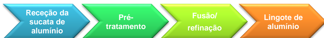
Figura 10 – Esquematização do processo de produção de alumínio secundário.
