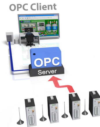
Figura 2.6: Fluxo de informação de um sistema servidor e cliente OPC. [22]
