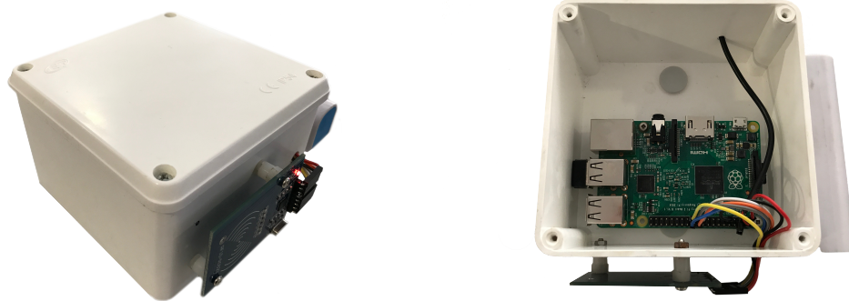
Figura 6.1: Dispositivo de monitorização dos AGV.
