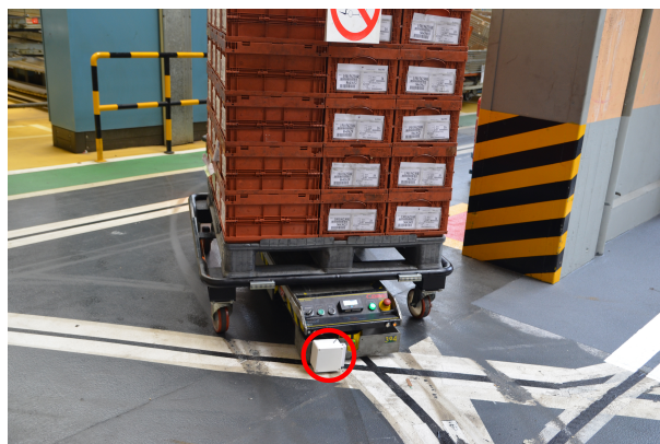
Figura 6.3: Montagem do sistema desenvolvido num AGV Cmajor.
