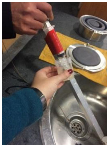
Fig. 4.17 - Momento em que se verte cuidadosamente a Água Mãe para cada copinho de 50 ml.
