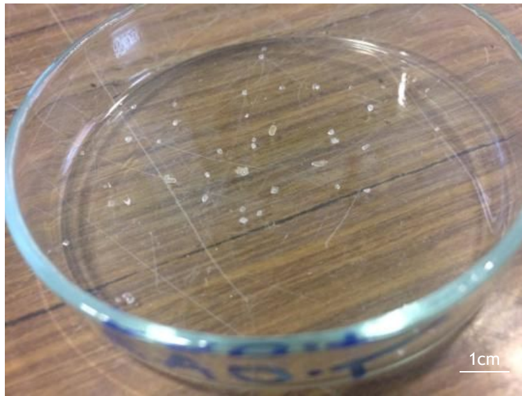
Fig. 4.38 - Amostras de cristais formados no tabuleiro b) correspondentes à polpa de “Argila Aveiro” “ Overflow ”, depois de secos.
