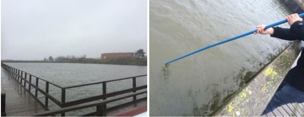
Figs. 4.3 e 4.4 - Imagem do primeiro Cristalizador da Salina de Santiago da Fonte alagado, de onde foi recolhida a amostra de Lama (fig. 4.3, à esquerda). Imagem do momento da colheita da amostra de Lama, usando uma pá de ferro azul com um cabo comprido (fig. 4.4, à direita).
