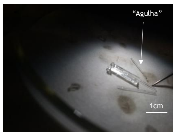
Fig. 4.31 - Amostra de "Agulha" analisada por Difração de Raios X.
