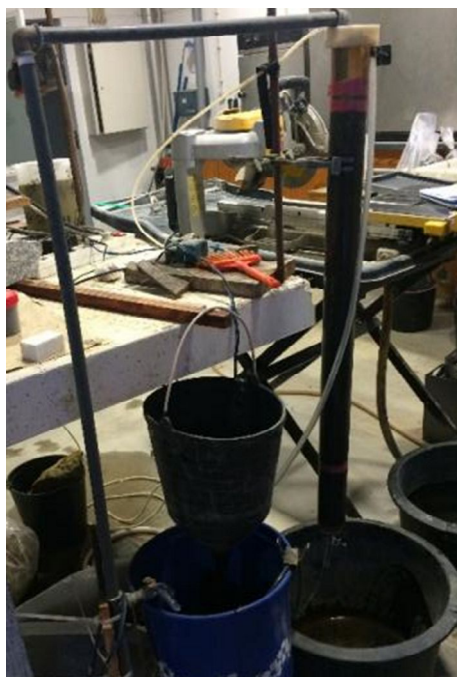
Fig. 4.20 - Equipamento desenvolvido no âmbito do trabalho de investigação de (Gomes J.H; 2015) e que também foi utilizado no âmbito da presente dissertação para Refinar/beneficiar e Separar a Lama e a Argila.
