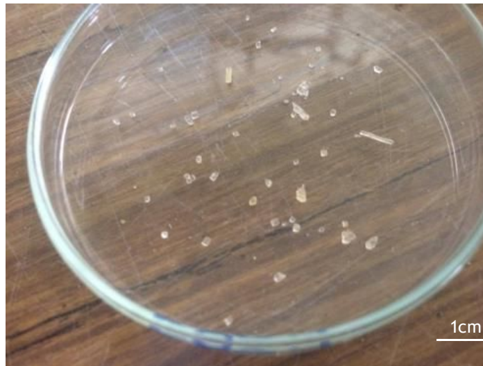
Fig. 4.36 - Amostras de cristais formados no tabuleiro b) correspondentes à polpa de “Argila Aveiro” “ Underflow ”, depois de secos.
