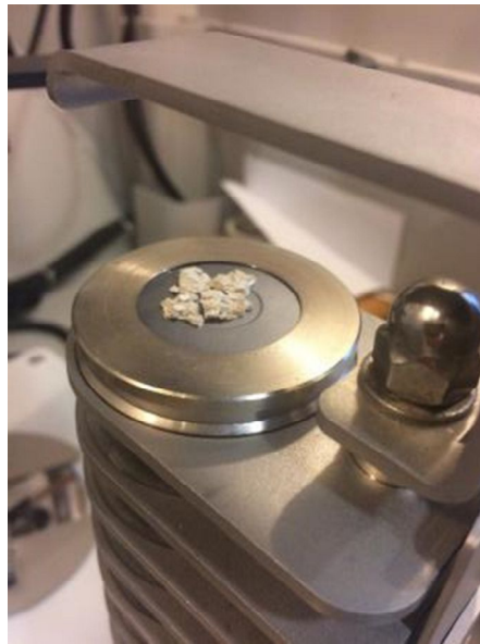
Fig.4.35 - Colocação, no porta amostras do Difractómetro, da amostra das crostas de cristais formadas no floculado de “Lama Primavera” “ Underflow ”.
