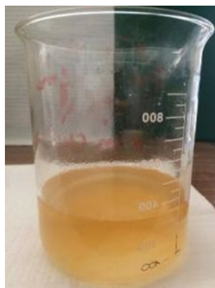
Fig. 4.40 - Recipiente com Água Mãe restante do processo de Refinação/beneficiação e Separação onde se formaram cristais de grandes dimensões.
