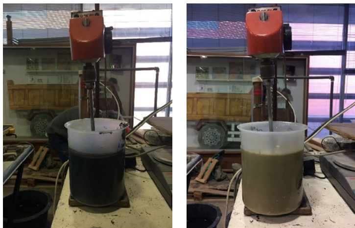
Figs. 4.18 e 4.19 - Imagem da agitação de um dos copos da polpa contendo Lama (fig. 4.18, à esquerda). Imagem da agitação de um dos copos da polpa contendo Argila (fig. 4.19, à direita).
