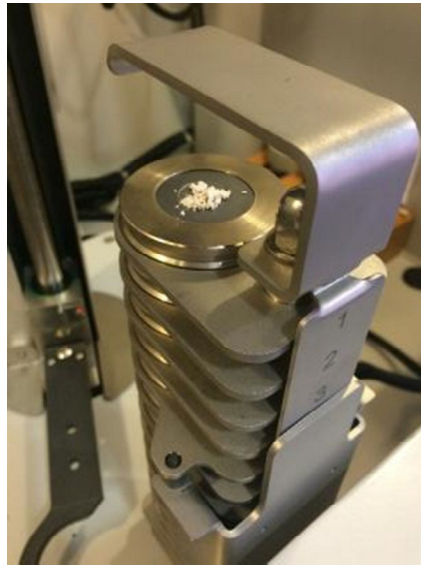
Fig.4.32 - Colocação, no porta amostras do Difractómetro, da amostra das crostas de cristais formadas no floculado de “Argila Aveiro” “ Overflow ”.
