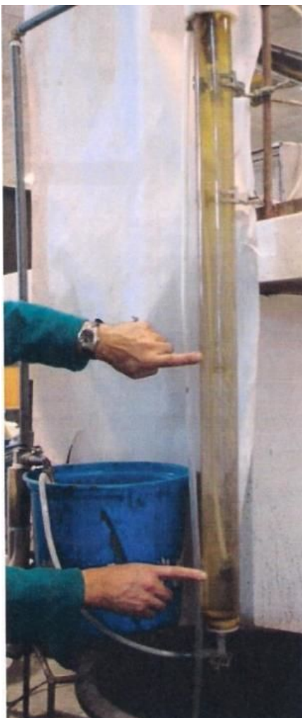
Fig. 4.22 - Imagem onde se observam os locais de saída da polpa (secção intermédia) e das bolhas de ar (secção inferior); Imagem retirada de (Gomes, J. H; 2015).
