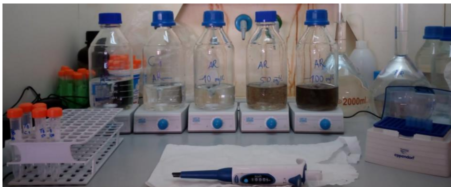
Figura 8 - Esquema do ensaio de sorção para 3 massas diferentes de sorvente, 10, 50 e 100 mg L -1 , com o controlo e o ensaio de sorção com carvão ativado comercial a decorrer em paralelo.
