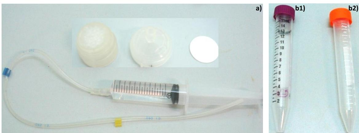
**Figura 2:** Materiais utilizados na separação de sólido-solução. **a)** seringa com o tubo de recolha e unidades de filtração; **b1)** tubo de centrifugação comercializado pela *VWR* de polipropileno com fundo cónico; **b2)** tubo de centrifugação comercializado pela *Orange Scientific* de polipropileno com fundo cónico.
