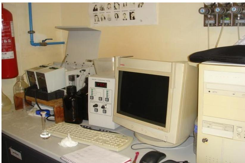
**Figura 3:** Fotografia do equipamento CV-AFS usado neste trabalho
