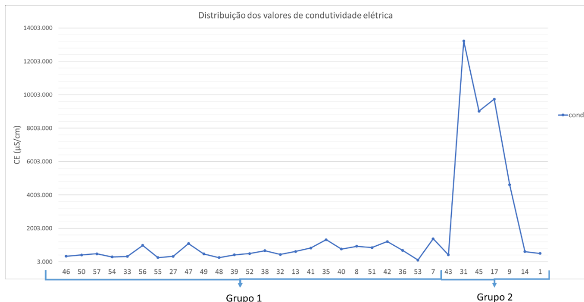
Figura 5.55 - Projeção ordenada das amostras dos 2 grupos definidos pela AC em função dos valores de condutividade elétrica
