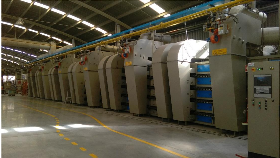
Figura 6 – Secador horizontal de seis módulos, a quatro planos, onde ocorre a secagem do grés porcelânico.
