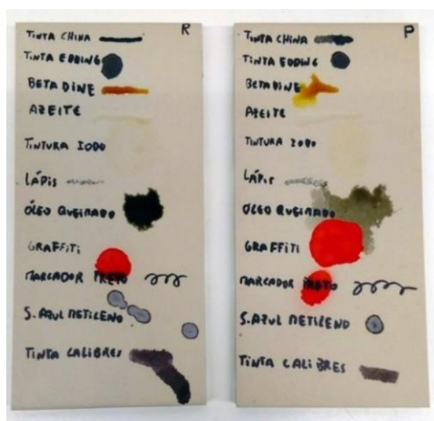
Figura 27 – Peças do lote de referência e do lote problemático após aplicação das manchas.
