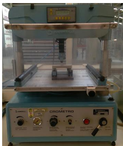
Figura 18 – Equipamento Gabbrielli CR4 onde se realizaram os ensaios de resistência mecânica.
