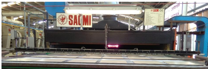
Figura 8 – Forno de rolos, de 104 m, para a cozedura do grés porcelânico.
