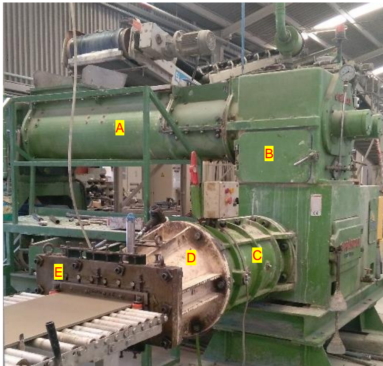
Figura 5 – Extrusora industrial onde ocorre a conformação do grés porcelânico. A – misturador de duplo eixo; B – cabine de vácuo; C – corpo da fieira; D – cabeçote; E – molde.
