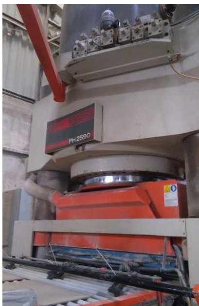
Figura 11 – Prensa PH2590 onde ocorre a conformação do grés porcelânico.
