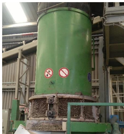
Figura 4 – Misturador vertical (ralador) de reaproveitamento de aparas. Na parte do fundo do ralador, pode ver-se a saída da pasta misturada.
