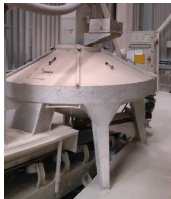
Figura 2 – Misturador circular ( bagnatrice ) de homogeneização das pastas provenientes dos diferentes silos.
