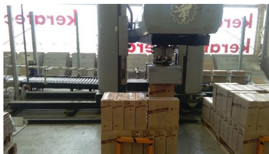
Figura 9 – Robô que empilha as caixas nas paletes.
