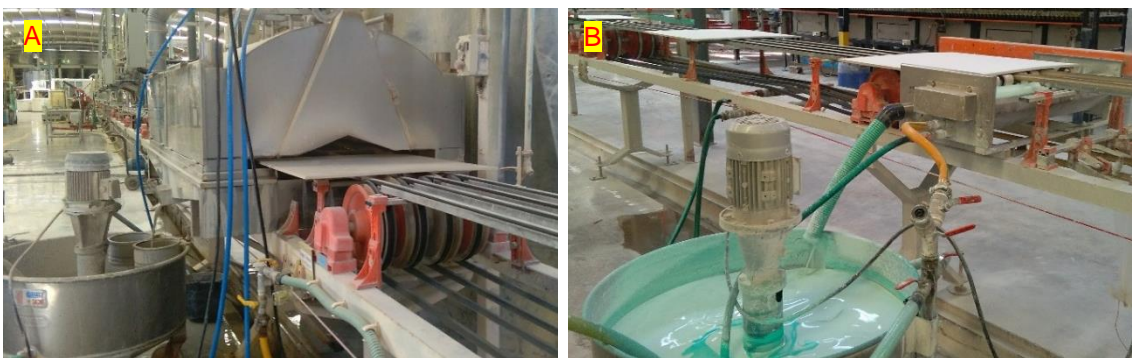
Figura 7 – Linha de vidragem: (A) onde se aplicam suspensões impermeabilizantes e (B) o engobe do tardez.
