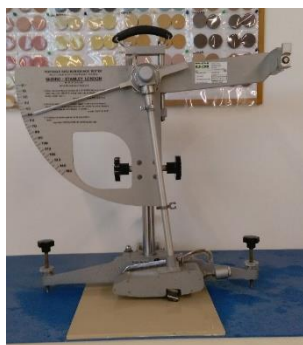
Figura 16 – Pêndulo utilizado para determinação do escorregamento das amostras dos lotes em estudo.
