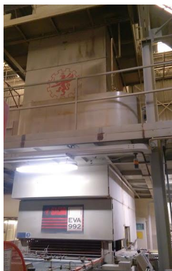
Figura 12 – Secador vertical EVA 992 onde se dá a secagem do grés porcelânico.
