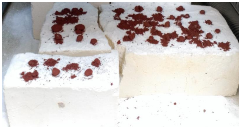
Figura 47 - Apresentação da destruição dos agregados cozidos com serrim.
