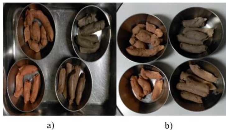
Figura 33 - Diferença entre pastas durante a medição da humidade de extrusão: a) pasta húmida e b) pasta seca.
