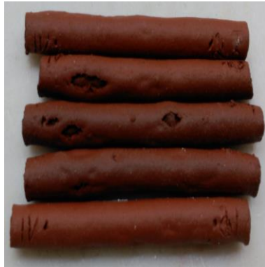
Figura 37 - Inchamentos e deformações ocorridas durante a cozedura em cerâmicos estruturais.
