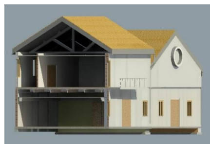
Figura 5.6 – Modelo 3D – Corte a meio do edifício.
