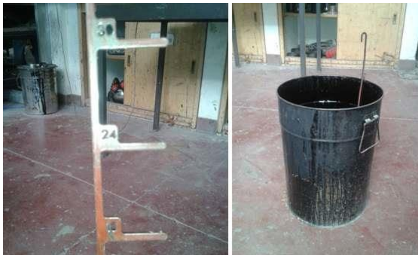
Figura 54 - Escala e balde utilizado para a medição da taxa de expansão e tempo de meia-vida.
