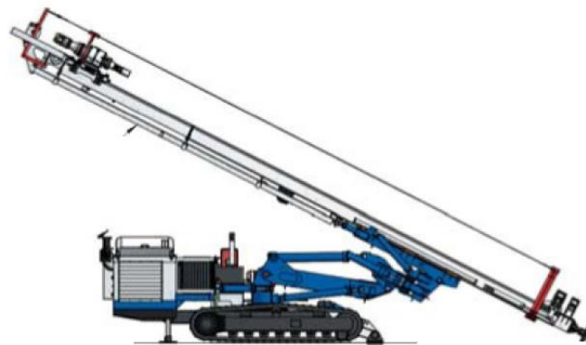
Figura 42 - Equipamento de Perfuração Micro-perfuradora Soilmec Modelo SM-20.
