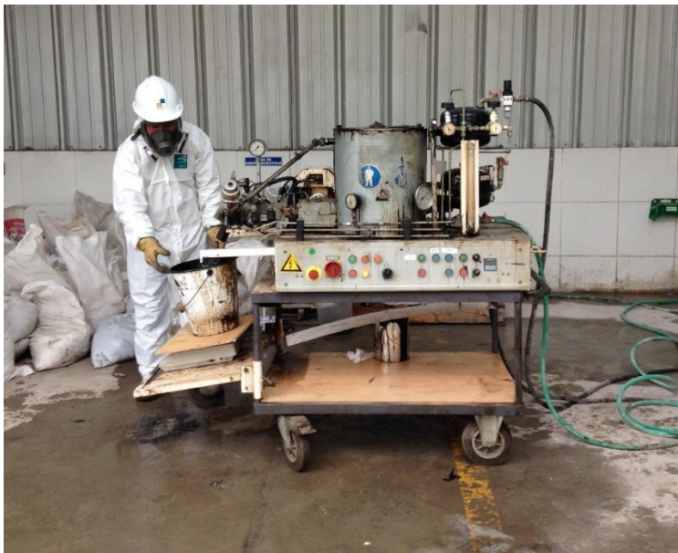
Figura 53 - Laboratório portátil Wirtgen WLB 10.
