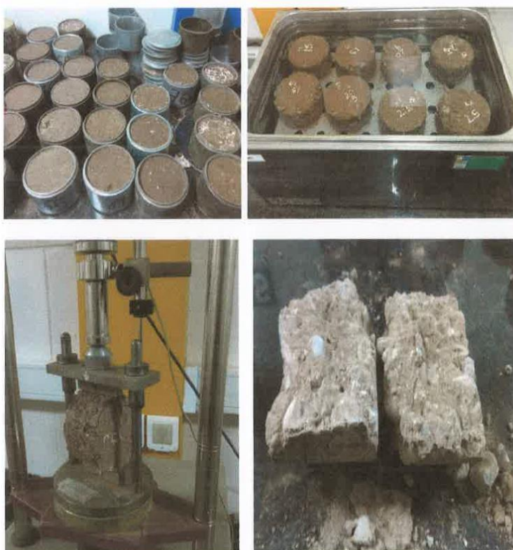
Figura 58 - Processo de formulação da mistura: Moldagem de provetes, cura e roturas mediante a tração indireta.
