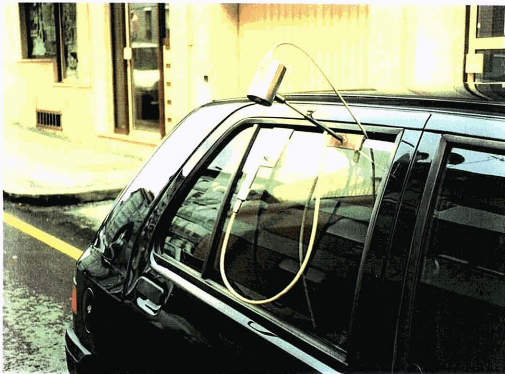
Figura I III 11 - Posição do Sensor da temperatura do ar e do Transdutor de temperatura por infravermelhos, no automovel, durante as medições itinerantes
