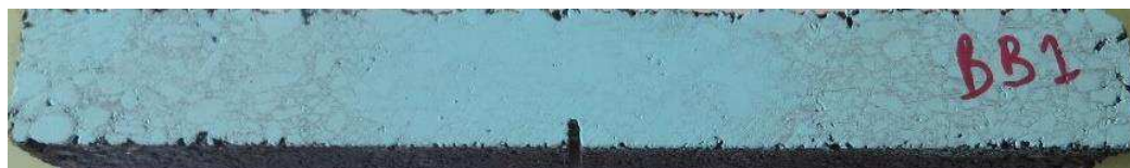
Figura 4.27 – Proвете betuminoso com fenda induzida
