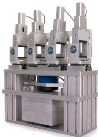
Figura 4.13 – Unidade de flexão do ensaio de flexão em quatro pontos
