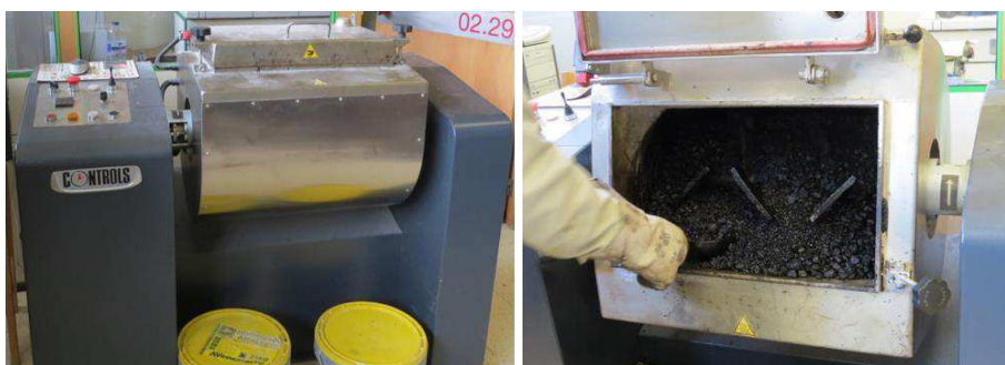
Figura 4.18 – Misturador Controls BITUMIX
