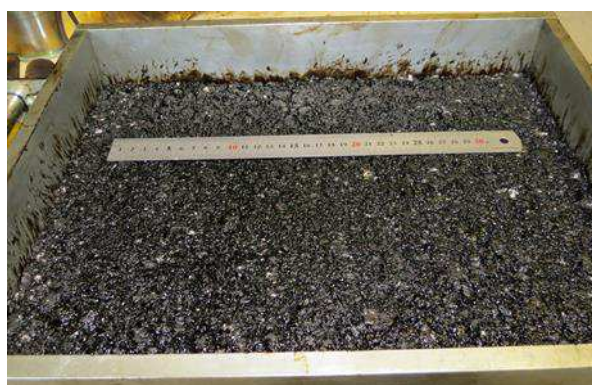
Figura 4.19 – Molde da laje com a mistura betuminosa compactada
