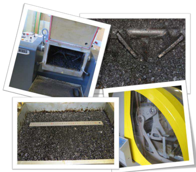
Figura 4.8 – Execução das lajes betuminosas
