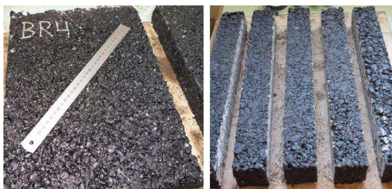
Figura 4.21 – Laje betuminosa antes e depois do corte em provetes
