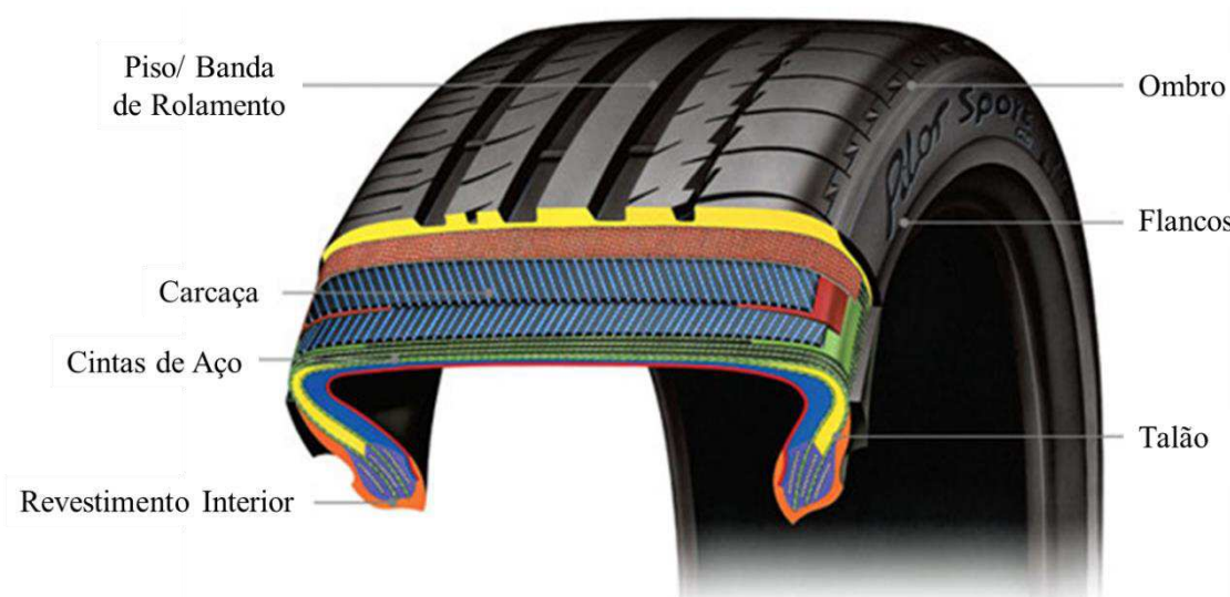
Figura 2.3 – Constituição de um pneu, adaptado de Steelmate (2016)
