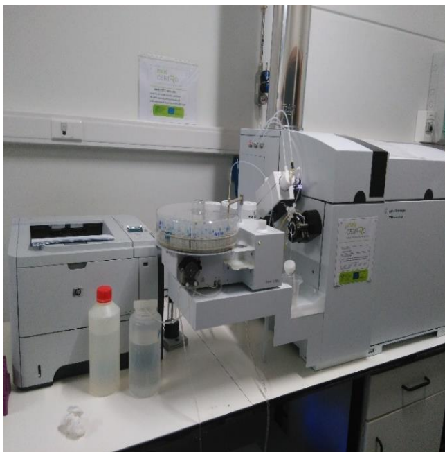
Figura 5.9 - ICP-MS Agilent modelo 7700, utilizado na análise química dos elementos maiores e vestigiais das amostras de águas.
