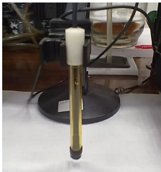
Figura 5.12 - Eléctrodo Seletivo \text{Ag}/\text{Ag}_2\text{S} (foto do autor, 2016)
