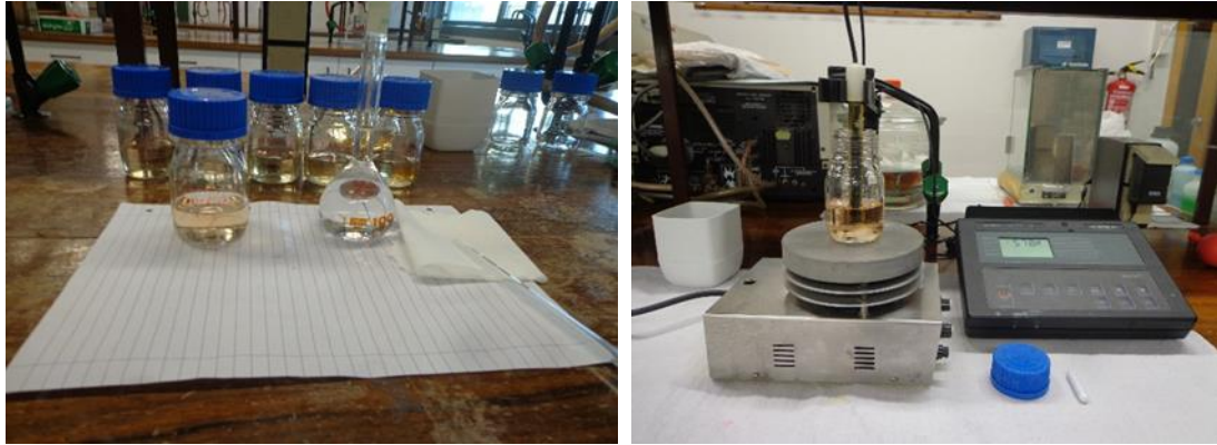
Figura 5.17 -Preparação das amostras e medição do potencial (foto do autor, 2016)
