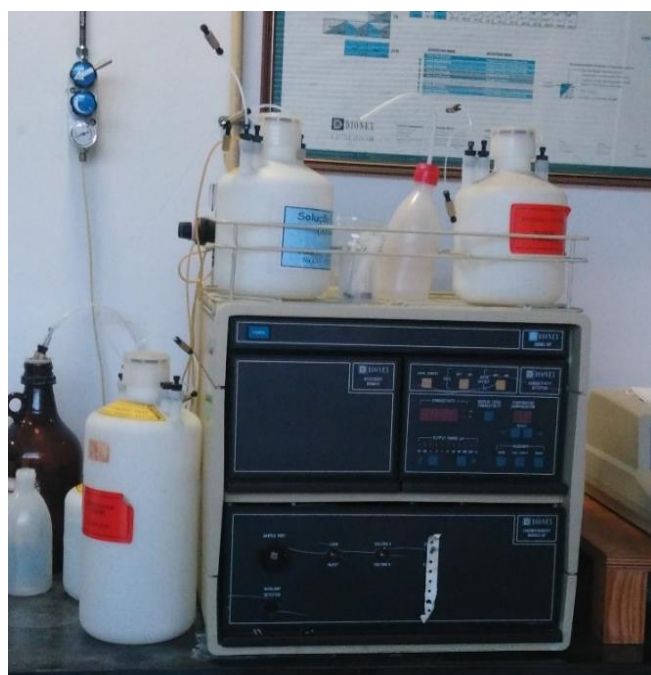
Figura 5.10 - Cromatógrafo da marca DIONEX, modelo 2000 SPI utilizado na análise aniônica das águas.
