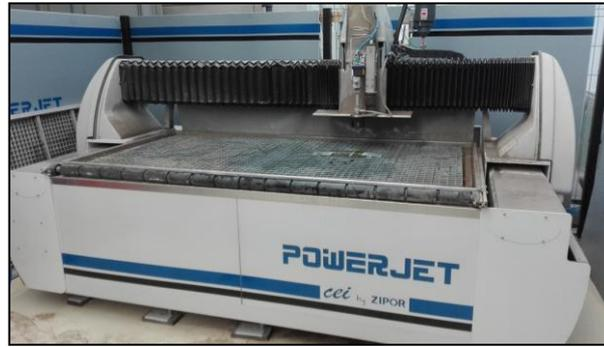
**Fig. 3.2:** Equipamento de corte por jato de água com agente erosivo existente na ESAN.
