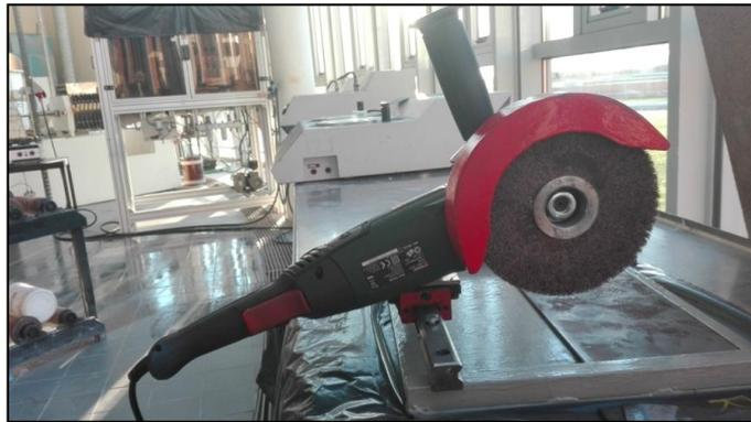
*Fig. 3.3: Máquina de escovas rotativas adaptado utilizado no trabalho.*
