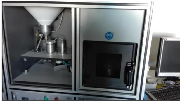
**Fig. 3.1:** Equipamento de jato erosivo utilizado no trabalho.
