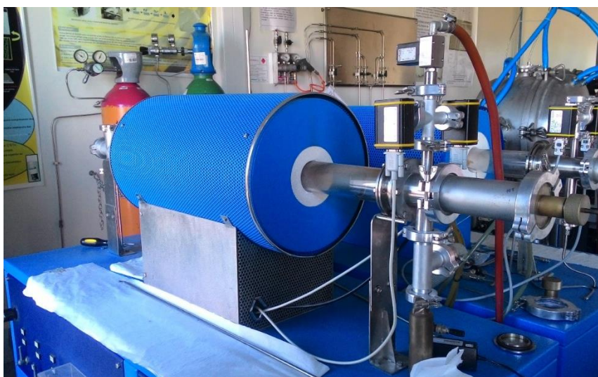
Figura 12 – Imagem do reator de TCVD home-made usado na síntese de nanotubos de carbono.
