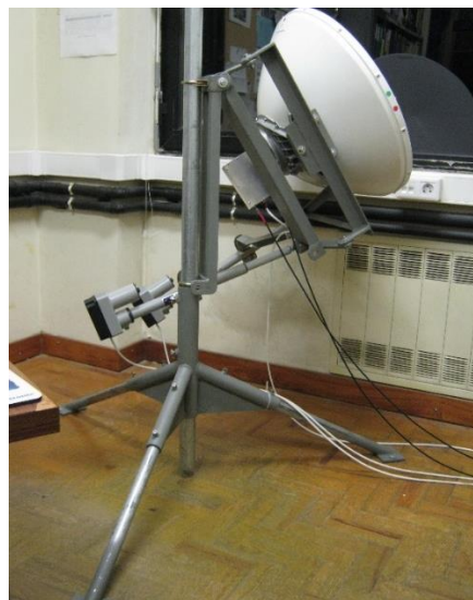
Figura 3.7- Antena e respetivo sistema de apontamento do sistema Alphasat
