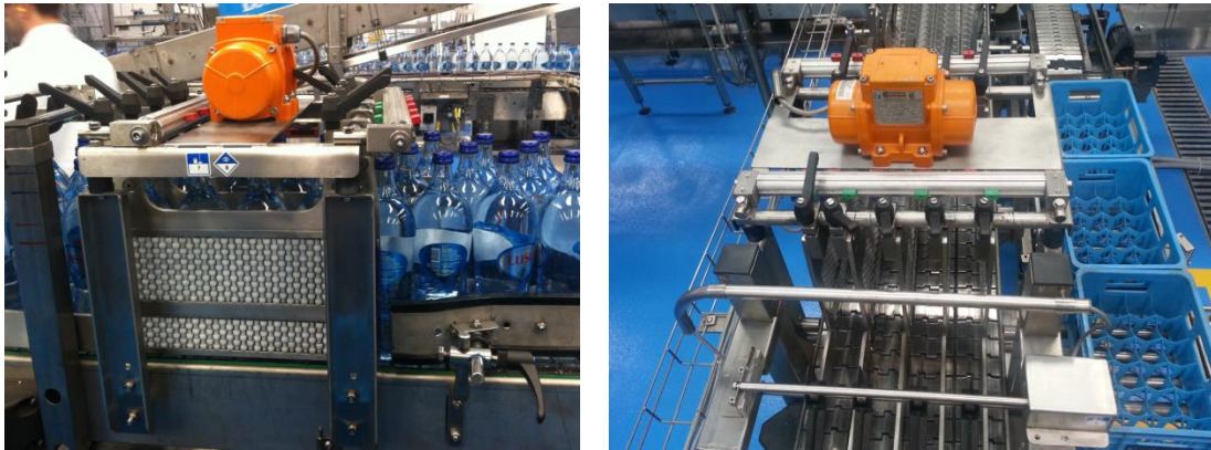
Figura 39 - Distribuidor com sistema vibratório e com paredes com os pequenos rolos.
