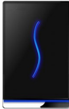
Figura 2.9: Dispositivo de controlo de acessos por cartão RFID [20].
