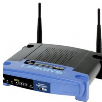
Figura 2.23: Um router sem fios utiliza a(s) sua(s) antena(s) para enviar sinais para os dispositivos sem fios e um fio para enviar e receber informações da Internet. [38].
