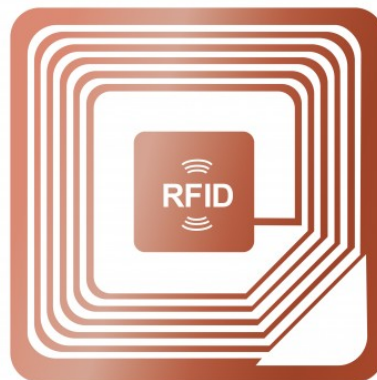
Figura 2.10: Exemplo de tag RFID [21].
