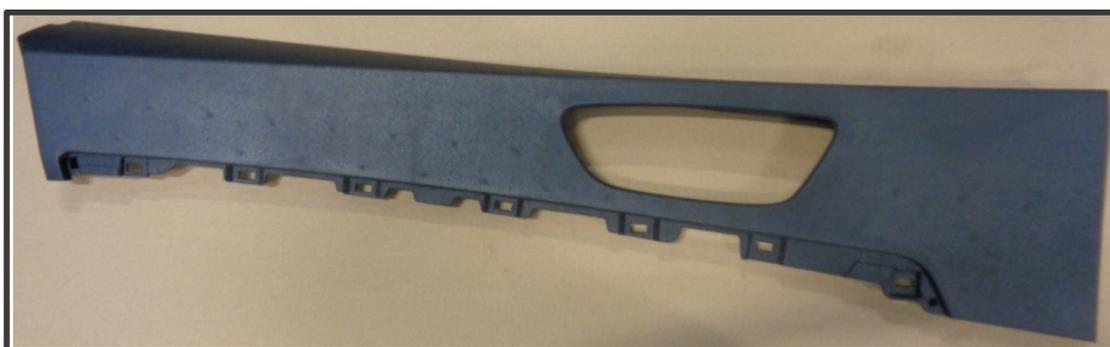
Figura 13 – Fotografia do substrato Tribu A em ABS, produzido por injeção.
