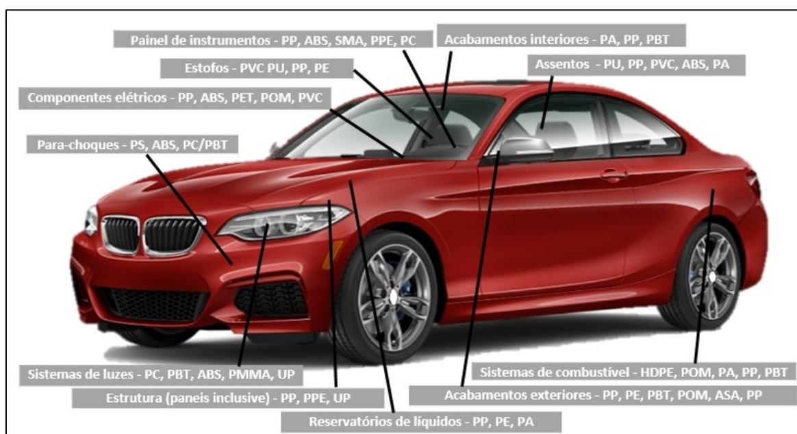
Figura 4 - Utilização de diferentes polímeros em componentes de automóvel, adaptado de [3][4].
