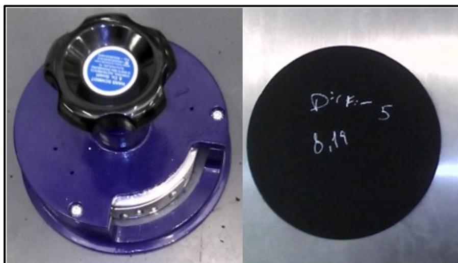
Figura 22 - Corta-amostras e amostra de PVC
