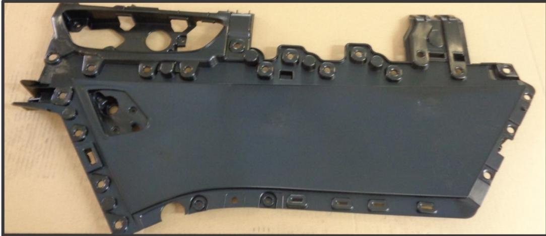
Figura 14 – Fotografia do substrato Tribu B em ABS, produzido por injeção.
